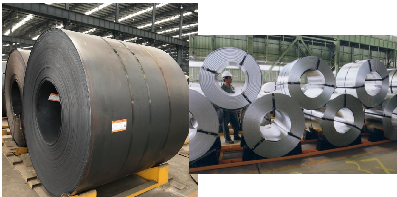
رول گالوانیزه کارخانه ای در کنار رول فولاد ST37 سیاه
